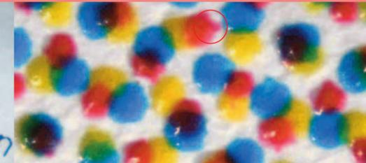
erhöhter Rakeldruck erforderlich, Tonwertabnahme, starke Farbtonverzerrung durch zu hohen Farbschichtaufbau
